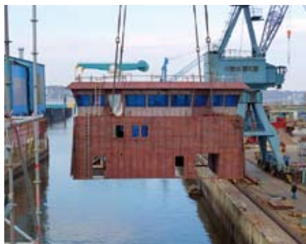
... nämlich die Brücke des Schiffes, die separat gefertigt wurde und hier als „fliegendes Deckshaus“ unterwegs zu ihrem Platz auf der „Uthlande“ ist.
