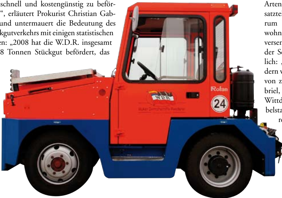
Ein „ZD 6“ von Rofan; die leistungsstarken Flurförderfahrzeuge haben 2008 die alten „Mulis“ auf den W.D.R.-Fähren ersetzt. (Foto: Bickel)
